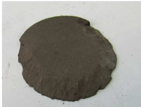
Рисунок 4 – Обломки брикетов, с науглероживателем в качестве связующего
