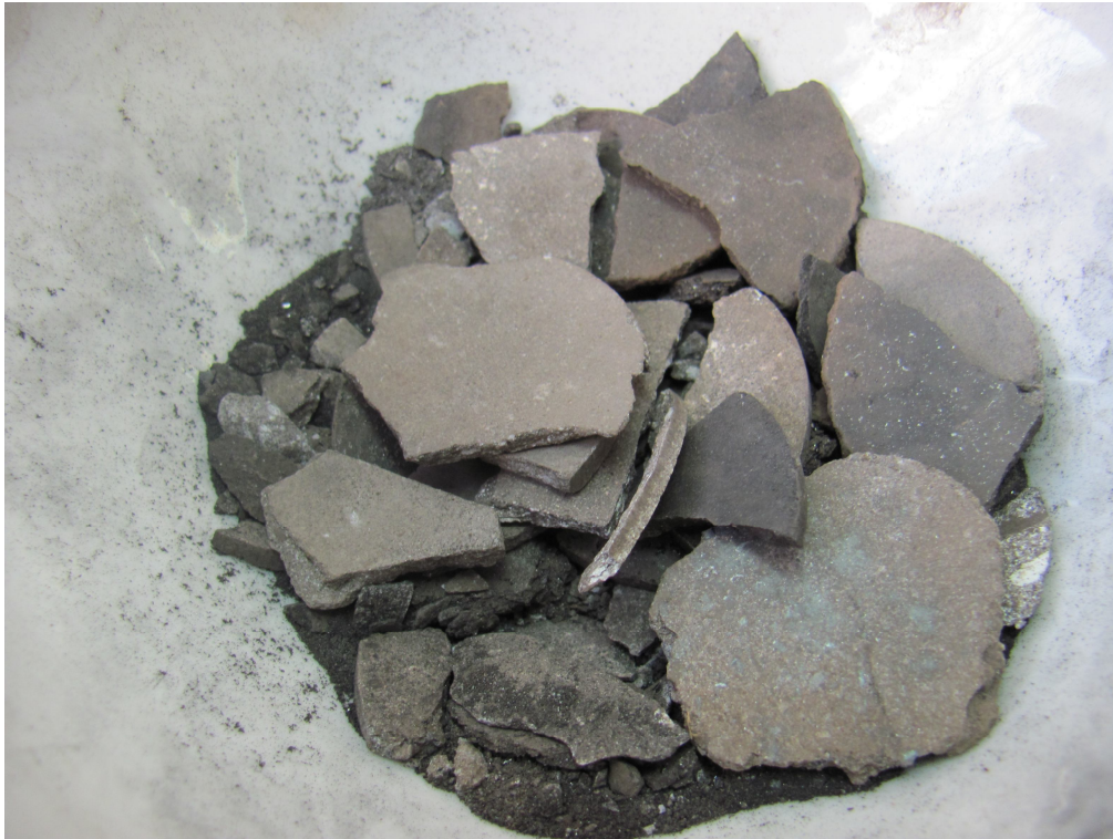
Рисунок 4 – Обломки брикетов, с науглероживателем в качестве связующего
