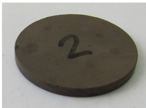
Рисунок 7 – Брикет, с клеем ПВА в качестве связующего, проба № 2
