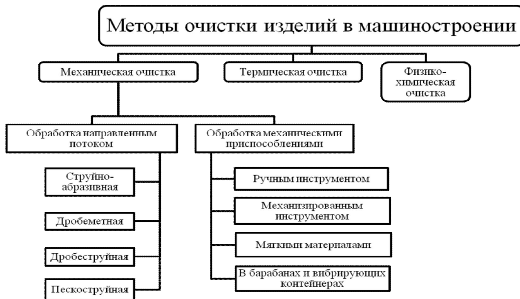
Классификация методов очистки изделий в машиностроении
