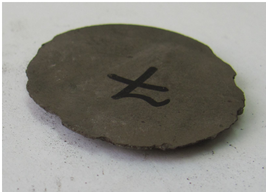
Рисунок 4 – Обломки брикетов, с науглероживателем в качестве связующего
