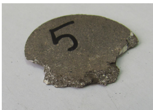
Рисунок 2 – Брикет с отсевом извести в качестве связующего
