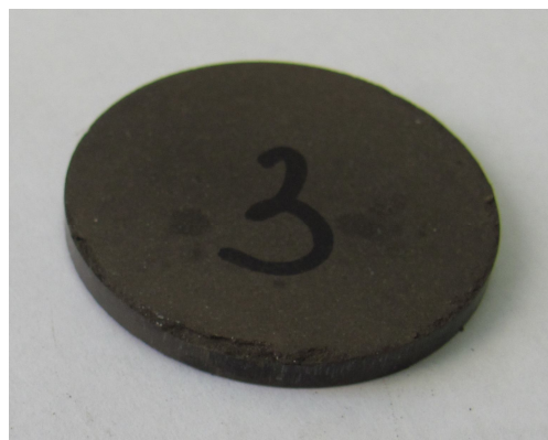
Рисунок 8 – Брикет, с клеем ПВА в качестве связующего, проба № 3
