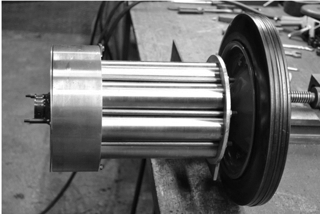
Рисунок 2 – Экспериментальный пневмопривод в сборе с колесом
