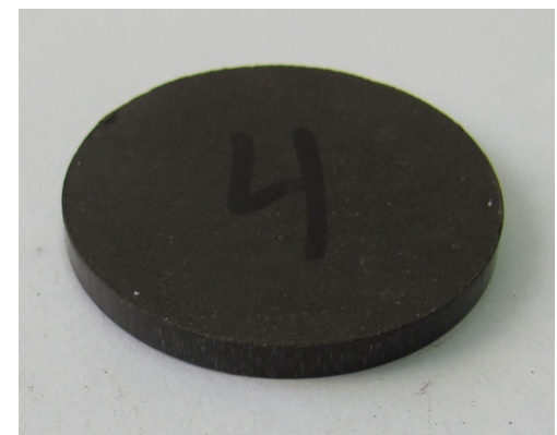
Рисунок 9 – Брикет, с клеем ПВА в качестве связующего, проба № 4
