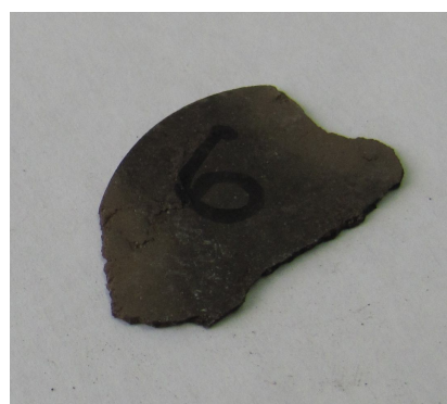
Рисунок 3 – Брикет с жидким стеклом в качестве связующего
